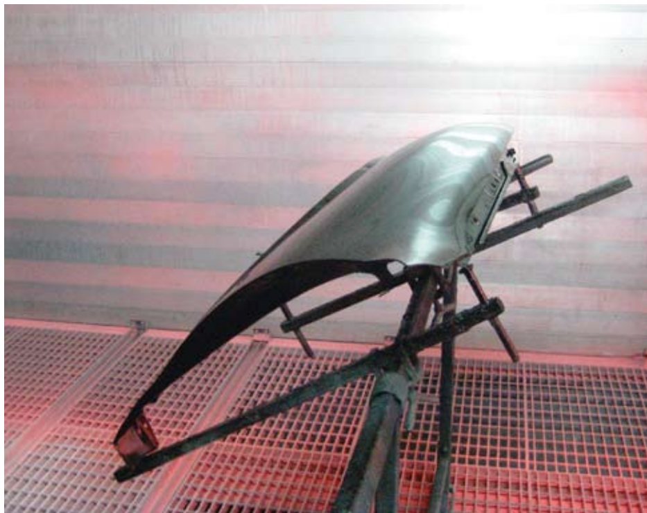
Bei 70 °C trocknen frisch lackierte Autoteile in der Trockenkammer.
